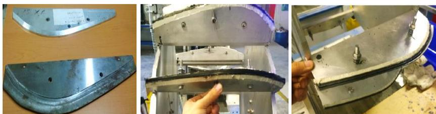
**Figura 3.** Aletas de aleación de aluminio y empaque elastomérico.
